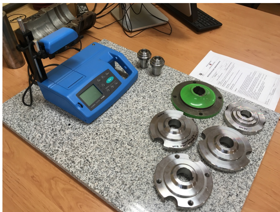
Rys.10. HOMMEL TESTER T1000 - profilografometr
