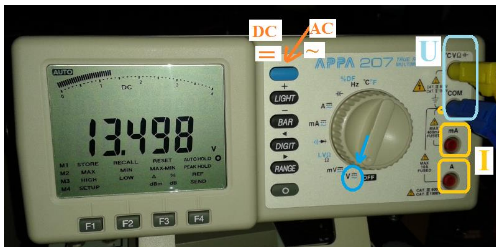
Rys. 5. Ilustracja miejsca podłączeń przewodów do multimetru APPA207 podczas pomiaru napięcia (niebieski przycisk służy do zmiany trybu pomiaru AC/DC, żółte czworokąty oznaczają miejsca podłączeń przewodów przy pomiarze prądu, COM – oznacza gniazdo wejściowe dla wszystkich pomiarów).
