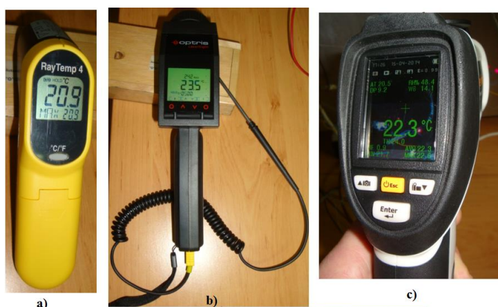
Rys. 8. Pirometry używane w laboratorium: a) RayTemp 4; b) Optris; c) Laserliner.
